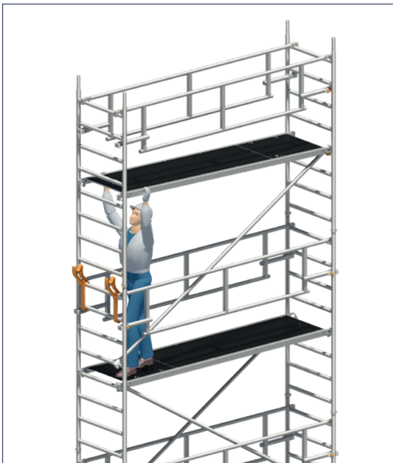
3 Diagonalen und Durchstiegsbrücke einsetzen.
