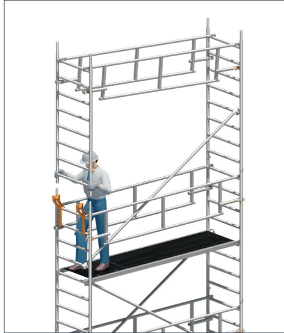
2 Standleiter mit Doppelgeländern nach oben schwenken und auf unterer Standleiter aufstecken.
