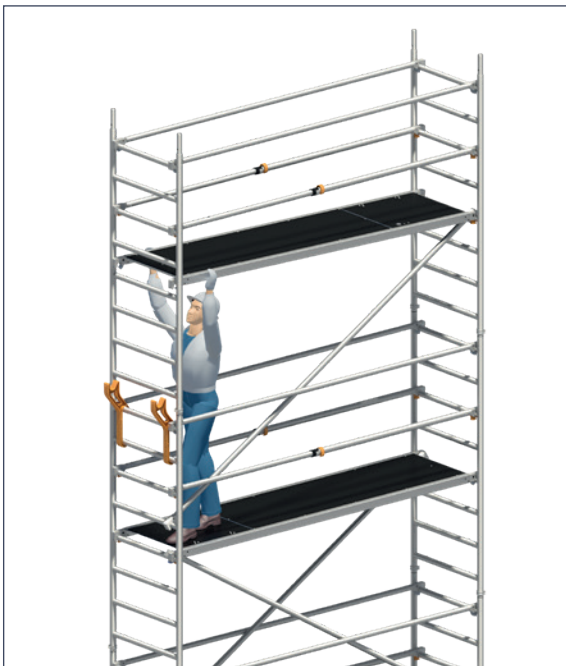
3 Diagonalen und Durchstiegsbrücke einsetzen.
