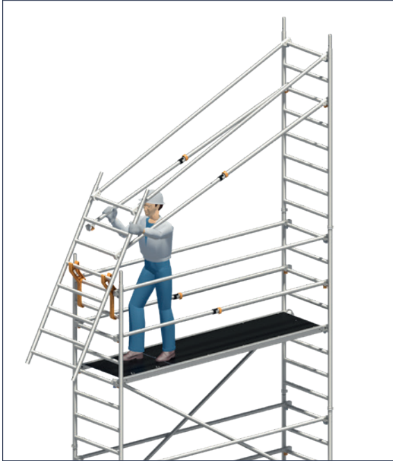
1 Aufstecken der ersten Standleiter. Anbringen der Uni Montagehaken und Positionierung der zweiten Standleiter zur Montage der Geländer und den Uni Telegeländern als Zwischenholme.
