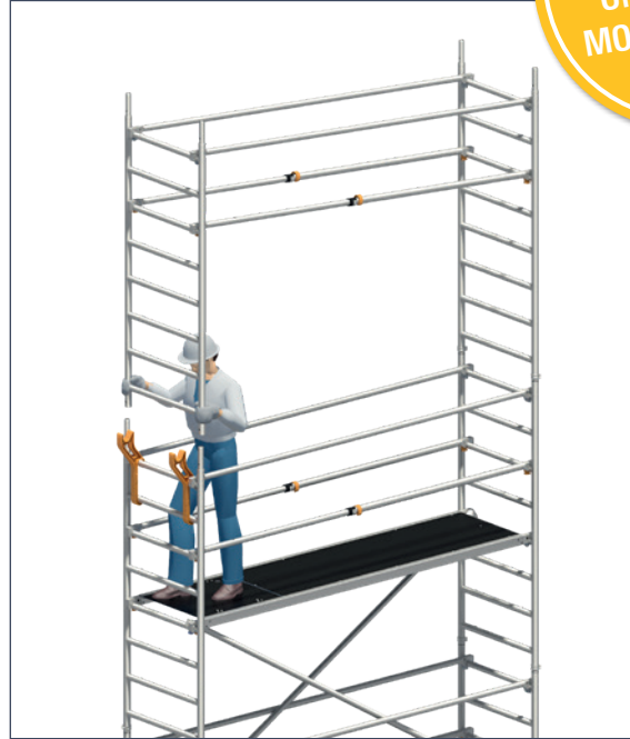
2 Standleiter mit den Geländern und Uni Telegeländern nach oben schwenken und auf unterer Standleiter aufstecken.
